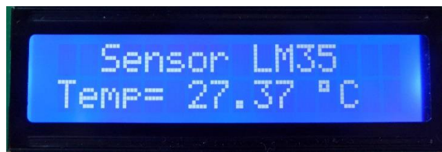
Figura 14. LCD mostrando el valor de la temperatura detectado con el sensor LM35.
