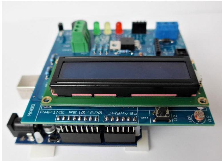
Figura 1. El módulo DASA siendo montado en una placa Arduino UNO.
